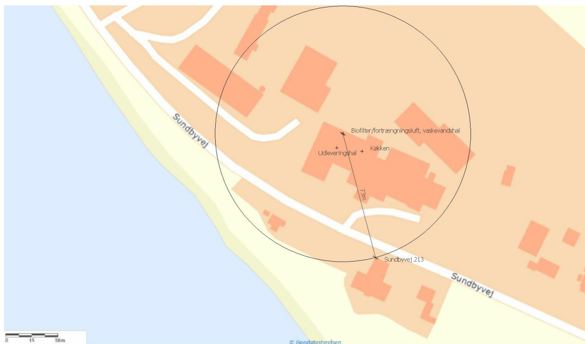
Figur 4 oversigt over Vildsund Minkfodercentrals anlæg, med målepunkter og afstande fra Biofilteret der er defineret som orion. Der er 73 meter til nærmeste nabo i en vinkel på 166°. GIS-kort fra geodatastyrelsens arealinfo.
